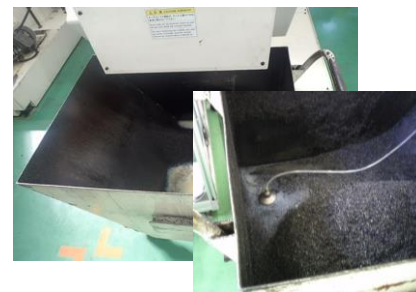
切粉台車に溜まったクーラントをリキッド コネクタで循環し利用
