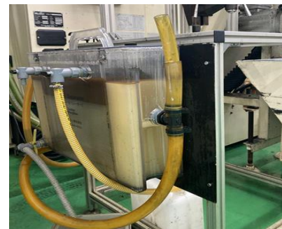
浮上油除去装置取り付けによる 切削水交換回数の削減
