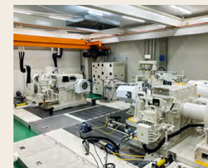
先進の試験設備(3輪ダイナモメーター)
