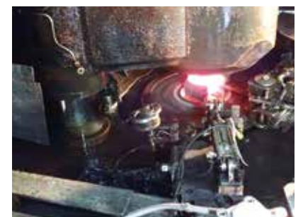
HAY GROUP が誇る設備と技術② 大型鍛造 3,000 ～ 5,000 トンの大型縦型鍛造プレスを保有し、熱間、温間、冷間のさまざまな鍛造ができます
