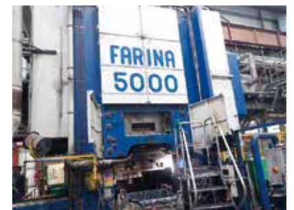
HAY GROUP が誇る設備と技術② 大型鍛造 3,000 ～ 5,000 トンの大型縦型鍛造プレスを保有し、熱間、温間、冷間のさまざまな鍛造ができます
