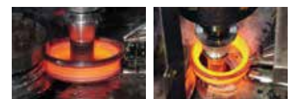
HAY GROUP が誇る設備と技術③ ローリング鍛造 ハテバー鍛造にローリング鍛造を組み合わせた加工は、歩留まりがよく、競争力が高くなっています
