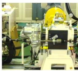
3軸ダイナモ試験機による車両模擬試験
