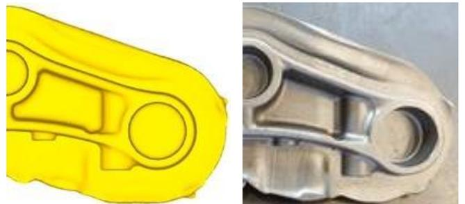
鍛造シミュレーションの例(左:シミュレーション 右:実際の加工品)
