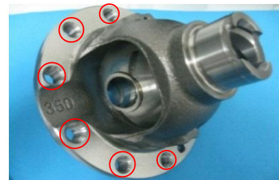
ネジ穴の加工方法を変更したデフケース
