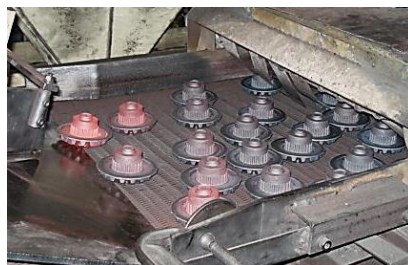
焼準炉へ材料を搬送するメッシュベルト
