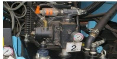
不稼働時の油圧ポンプの自動停止
